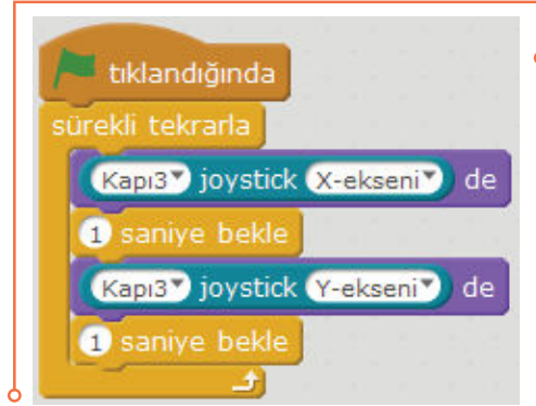
Resim 6.84: Joystick kullanım örneği
