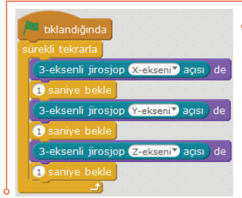
Resim 6.83: Jiroskop algılayıcı kullanım örneği
