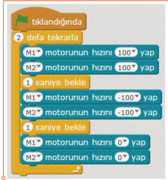
Resim 6.55: mbot Robotun hareketi için DC motor kullanım örneği
