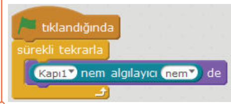
Resim 6.79: Nem ve sıcaklık algılayıcı kullanım örneği
