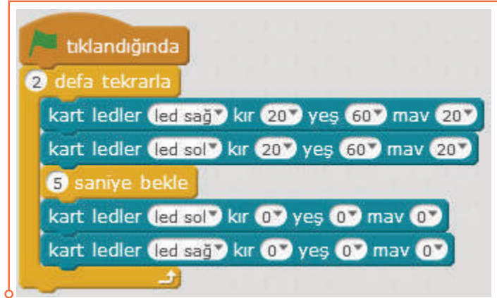
Resim 6.56: mbot Robot üzerindeki RGB LED kullanım örneği
