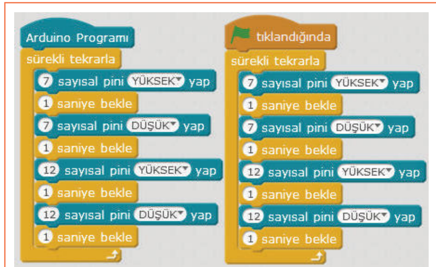
Resim 6.45: Arduino UNO ile LED uygulaması örneği
